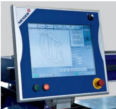
El control CNC "Global Control" puede estar situado en la máquina o individualmente.
