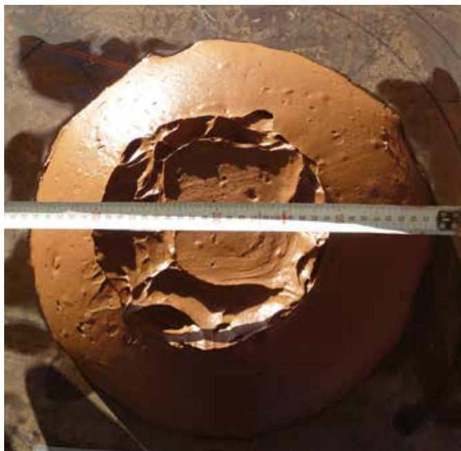
Relleno sin aditivo
