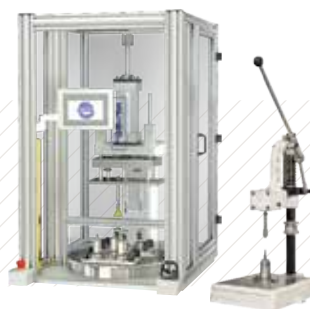
Tecnología de Instalación de Limitadores de Compresión
