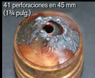
41 perforaciones en 45 mm (1¾ pulg.) Competidor A sin tecnología PowerPierce
