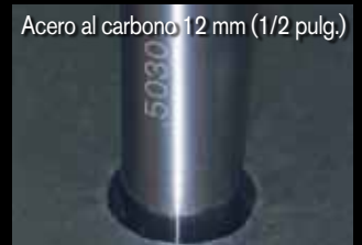
Acero al carbono 12 mm (1/2 pulg.) Orificio de 12 mm (1/2 pulg.) sin tecnología True Hole
