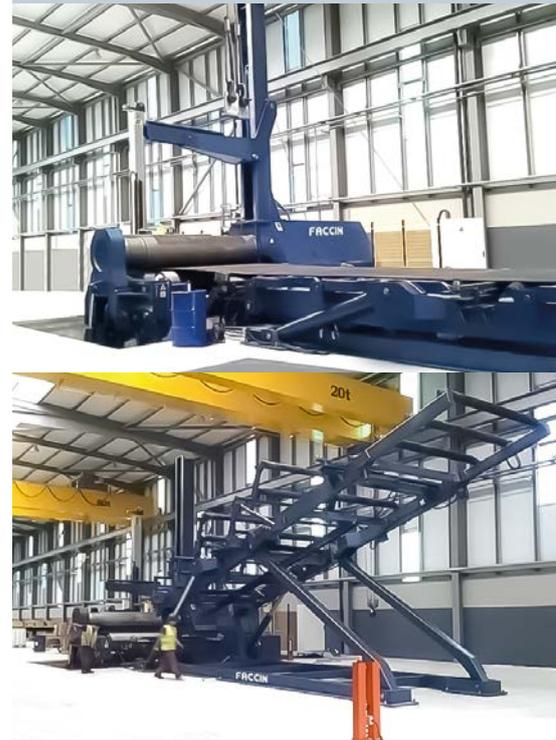
Los sistemas de control numérico SIEMENS están disponibles en todas las versiones de la serie 4HEP para el control preciso de mesas de alimentación y los sistemas automáticos de carga y descarga cuando se desea crear una línea completamente automática.
