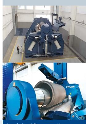
Las máquinas 4HEL son reconocidas por su fiabilidad gracias a que poseen una estructura sobredimensionada y al sistema de lubricación centralizado. El diseño de la guía lineal (RGS) aumenta la precisión del curvado minimizando la distancia entre los puntos de curvado.
