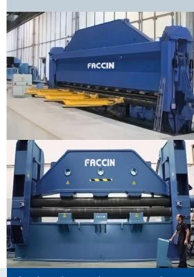
Gracias al control constante de todos los ejes durante el ciclo de curvado, las máquinas de la gama RP de Faccin ofrecen un producto final de calidad superior, minimizando la necesidad de una calibración posterior.
