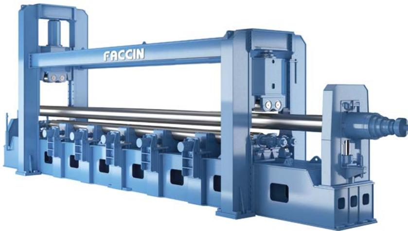
Faccin tiene muchos años de experiencia en el diseño y fabricación de máquinas especiales para la producción de tuberías/gasoductos. Para satisfacer las necesidades específicas de producción del sector, la empresa ofrece el modelo HAV-2P, una serie de roladoras de alto rendimiento capaces de ejecutar la producción de tuberías proporcionando productividad, repetibilidad y automatización del proceso íntegro.
