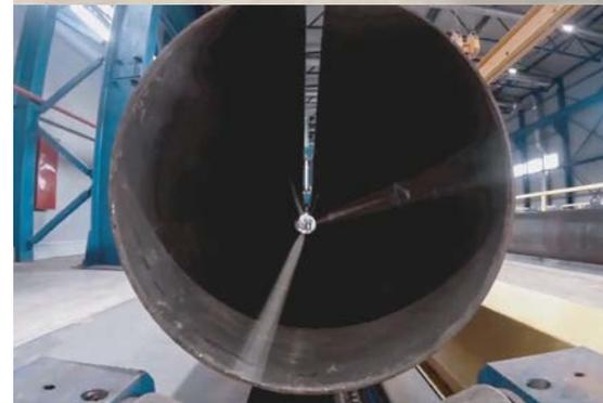
Las roladoras de la serie HAV-2P están diseñadas para curvar láminas de hasta 45 mm de espesor, ideales para la producción de tuberías hasta 18m de largo, cumpliendo con las especificaciones técnicas y tolerancias de redondez, además de ofrecer un producto final de alta calidad en conformidad con los estándares API.
