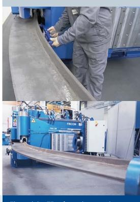
El modelo FB ofrece la completa automatización del proceso de curvado gracias a las unidades de control numérico opcionales (CNC). El CNC controla automáticamente la alimentación del perfil y los movimientos de los brazos de curvado permitiendo de este modo que el proceso sea completamente automático y sin la necesidad de un operador.
