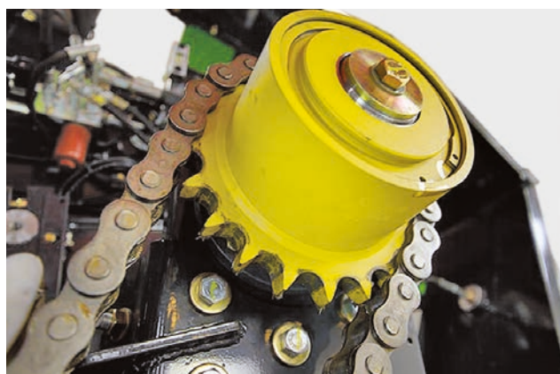
EMBRAGUE DE PROTECCIÓN DEL ROTOR CON TECNOLOGÍA INTEGRAL
