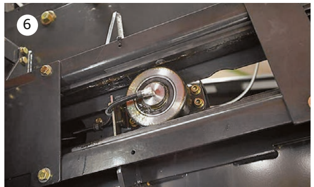
PISTÓN DE GRAN CAPACIDAD: 46 IMPULSOS POR MINUTO; RODAMIENTOS DEL PISTÓN DE 12,5 CM
