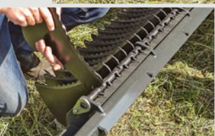
SISTEMA DE MÓDULOS DE LAS CUCHILLAS
