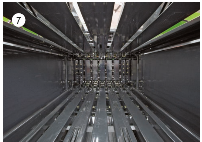
CÁMARA DE EMPACADO DE 3 M, CON MECANISMO DE EXPULSIÓN DE LA PACA
