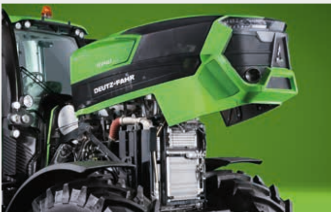
↑ El capó con apertura eléctrica facilita el acceso para realizar las operaciones de mantenimiento.
