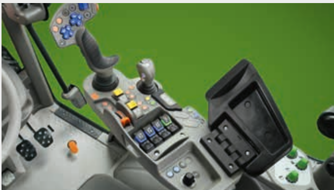
↑ El reposabrazos MaxCom con joystick ergonómico y funciones claramente identificadas por códigos de color.
