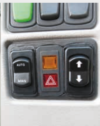
↑ Control independiente entre el BALANCE delantero y el sistema de nivelación trasero, tanto con función automática como con función manual.
