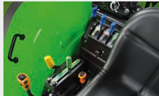
↑ Transmisión, elevador trasero y mandos de los distribuidores.
