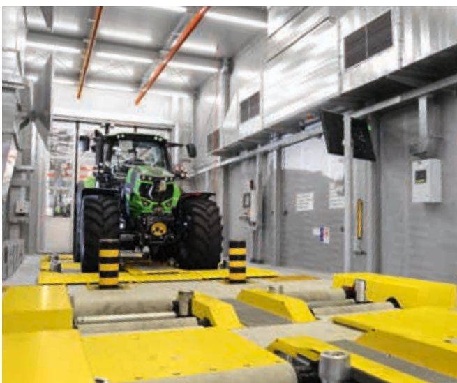
↑ Exclusivo en la producción de tractores: los dinamómetros de ejes y chasis (Lauingen, Alemania).
