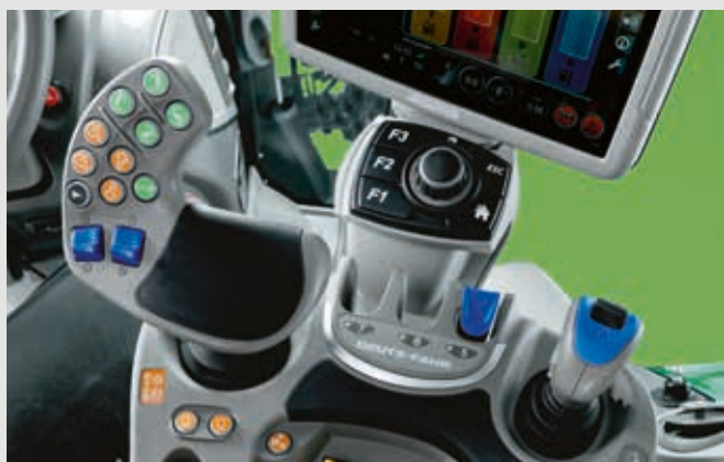
Joystick MaxCom y mandos hidráulicos ergonómicos.
