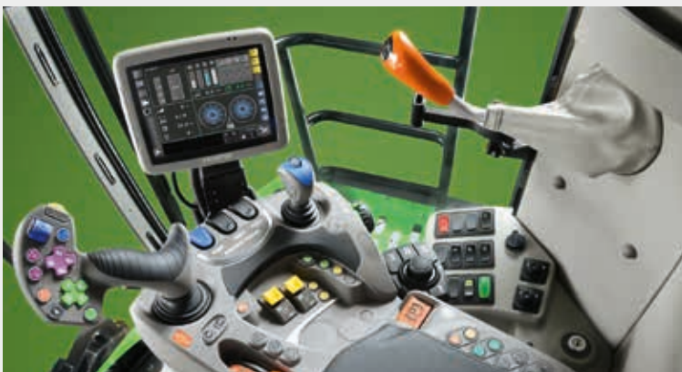
↑ Con el reposabrazos ergonómico, que integra el COMMANDER STICK y el iMonitor, podrá realizar todos los ajustes de la cosechadora fácilmente y sin esfuerzo.
