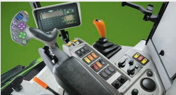
↑ Cabina moderna, con panel de mandos muy cómodo y columna de dirección regulable en tres posiciones.
