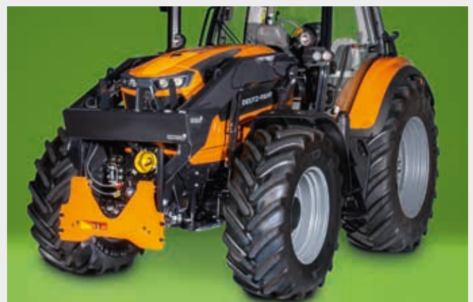
↑ Bastidor de soporte Sauter con paleta común regulable (categoría 3/5) y soporte del eje para cargas pesadas en el implemento y estabilizadores.
