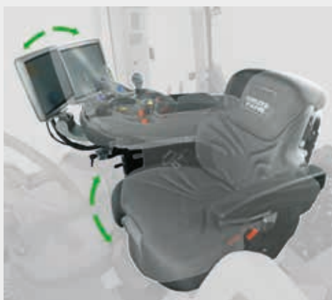
↑ Novedad en todos los modelos TTV: asiento con rotación de hasta 23° para un mayor confort operativo y de trabajo.
