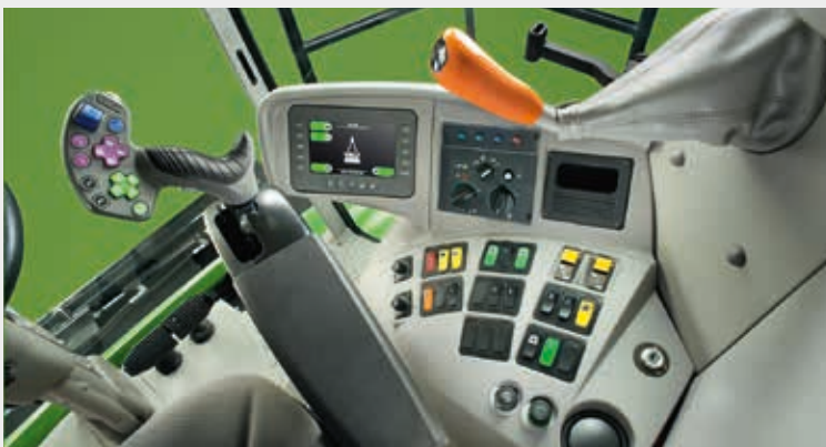
↑ Todos los mandos al alcance, palanca multifunción COMMANDER Stick y pantalla táctil de 7" visible con cualquier condición de luz.
