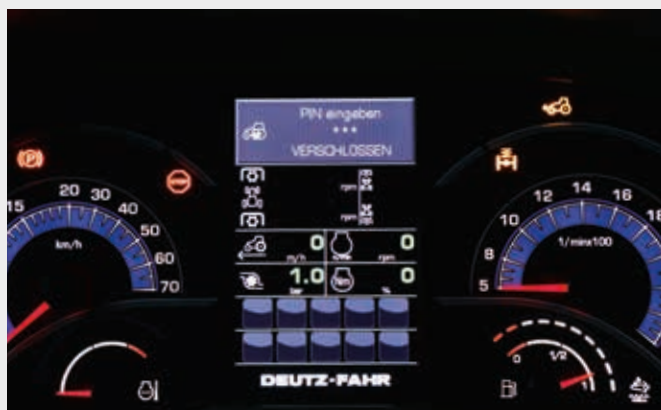
Panel de instrumentos de última generación con InfoCentrePro; Pantalla a color de 5" de alta resolución para un concepto de información definido por el usuario, del más alto nivel. Seguridad garantizada gracias al bloqueo con código: Bloqueo y desbloqueo con PIN.
