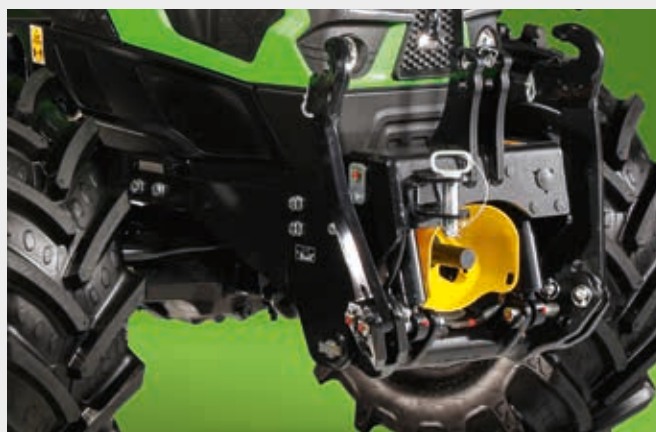
Los modelos 5D se pueden equipar opcionalmente con el nuevo elevador delantero Sauter.
