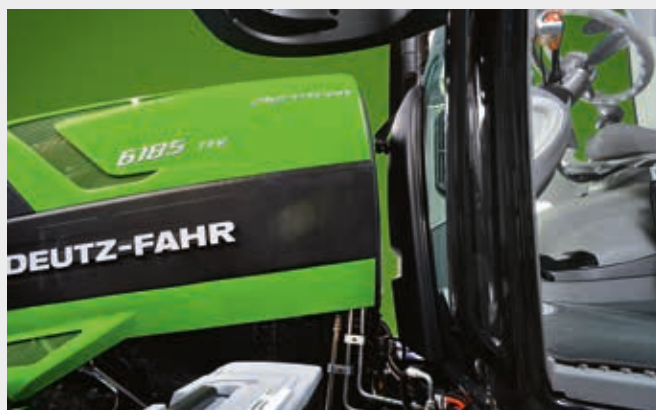
La cabina y el capó están separados para reducir el ruido y las vibraciones, aumentando el confort.
