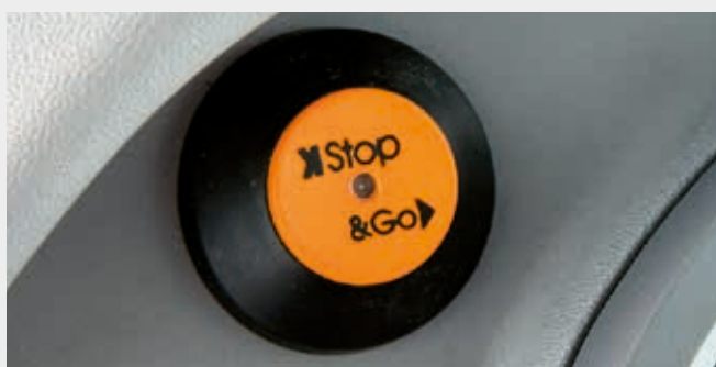
↑ Con la función Stop&Go, podrá controlar el movimiento del tractor solo con los pedales de freno, sin tener que tocar ni siquiera el pedal del embrague.
