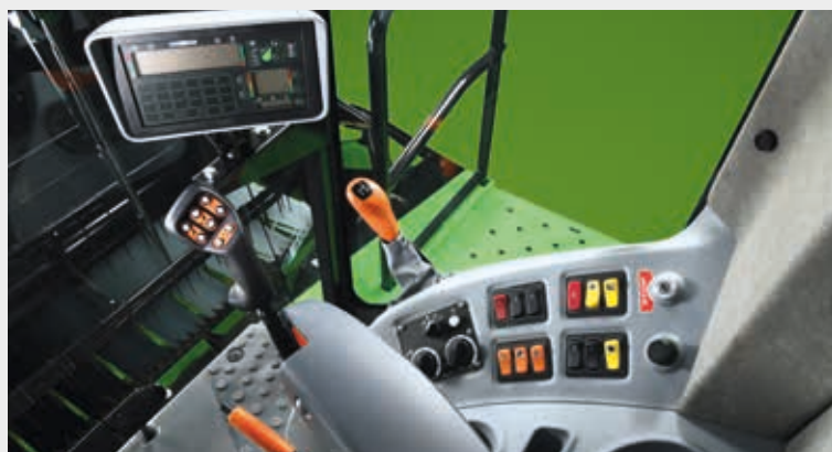
La consola tiene todos los elementos de mando al alcance del conductor. El reposabrazos con Commander Stick garantiza una perfecta comodidad de manejo.
