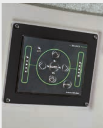
↑ Control independiente entre el BALANCE delantero y el sistema de nivelación trasero, tanto con función automática como con función manual.
