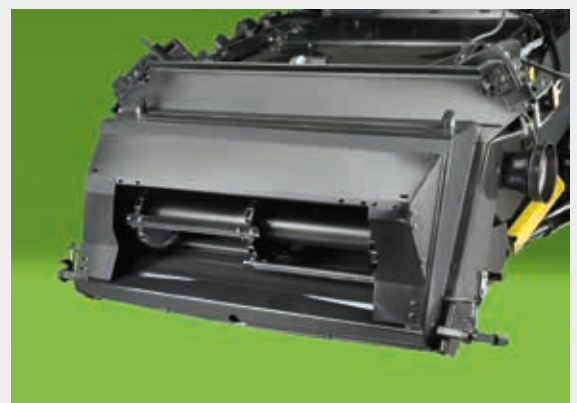
↑ Gracias a la gran anchura del canal de alimentación, el sistema de trilla no se ve limitado cuando trabaja con grandes cantidades de producto.
