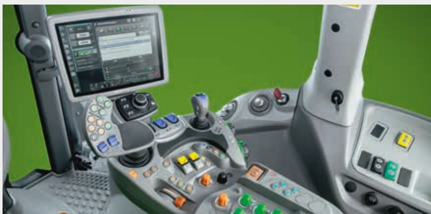
↑ El reposabrazos MaxCom de la Serie 7 TTV integra todos los controles principales y permite una gestión total de la máquina.
