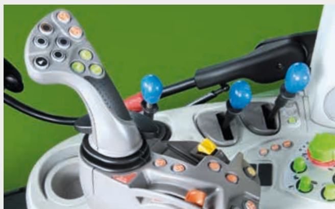
↑ El nuevo joystick MaxCom, muy ergonómico, situado en el reposabrazos, lo controla todo. Controles específicos para la velocidad de conducción, el sentido de la marcha, sistema ComfortTip y mandos del elevador trasero. Además: cuatro botones programables para ofrecer la máxima flexibilidad.
