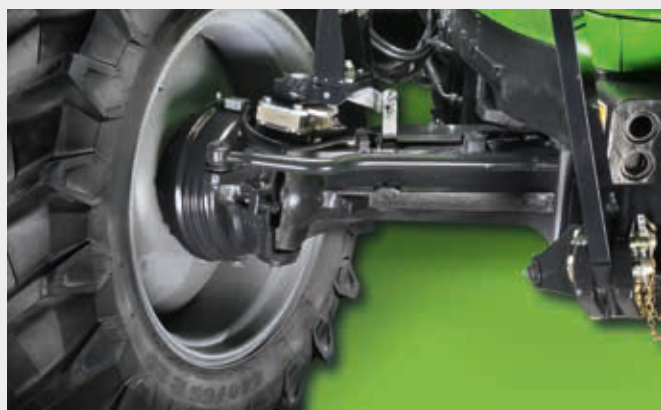
↑ Eje delantero equipado con frenos de disco.
