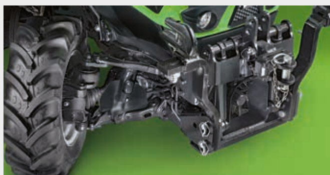
↑ Puntos de enganche frontales. Equipado para cualquier aplicación.
