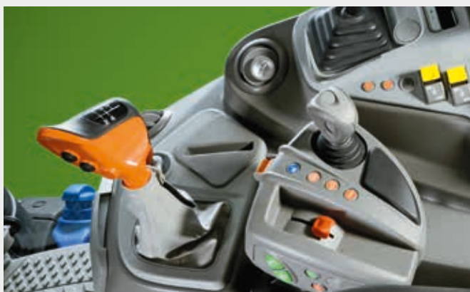
↑ Transmisión Powershift de seis cambios bajo carga.
