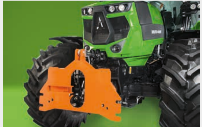
↑ Acoplamiento Sauter para servicios urbanos (categoría 3/5). Para un montaje rápido y resistente de los aperos especiales.
