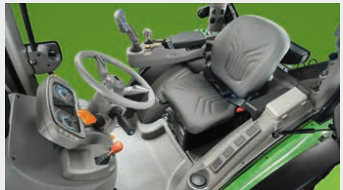
↑ Espaciosa cabina de 4 montantes, con suelo completamente plano gracias a la transmisión compacta TTV de baja altura.
