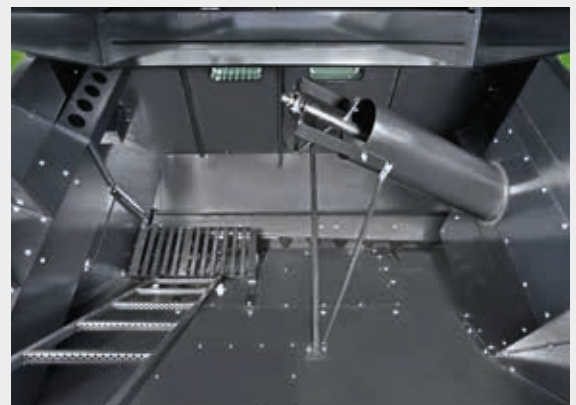
↑ Tolva de grano de 7.000 litros para reducir al mínimo las paradas de descarga.
