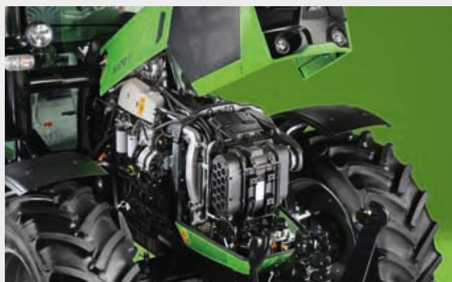
↑ Motor FARMotion con sistema SCR de postratamiento de los gases de escape.
