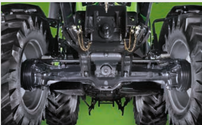
↑ La suspensión del eje delantero garantiza un mayor confort de conducción, seguridad y tracción.
