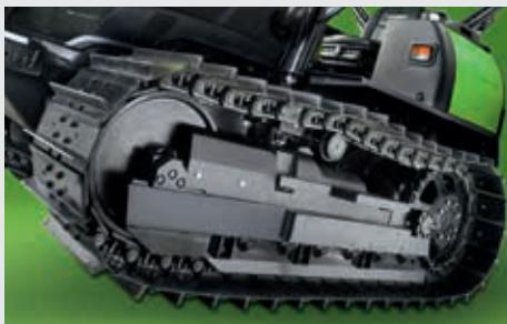
↑ Novedoso sistema de orugas con seis rodillos de apoyo para garantizar la máxima estabilidad y tracción.
