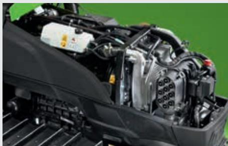
↑ Eficiencia compacta. Motores FARMotion con cilindrada optimizada, ventilador Visco y filtro de aire PowerCore.
