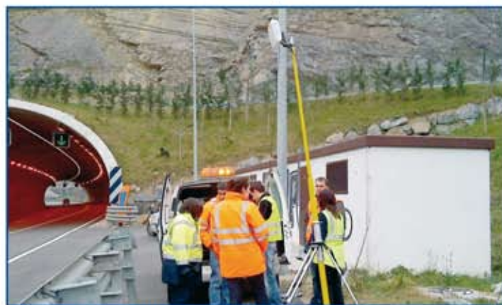
Aforo lateral no intrusivo por tecnología radar
