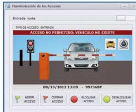
Ejemplo de monitorización de acceso
