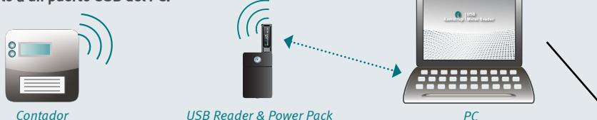
2. O bien puede leer el contador usando un USB Meter Reader conectado a un Power Pack y transferir los datos directamente, sin desconectar el Power Pack, si cuenta con otro USB Meter Reader permanentemente conectado al PC.
