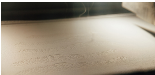
Figura 2. Sinterización selectiva por láser utilizada para producir la entresuela
