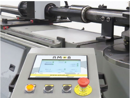
Pantalla táctil de fácil utilización El control con pantalla táctil permite una fácil programación de las piezas, intuitiva y rápida.
