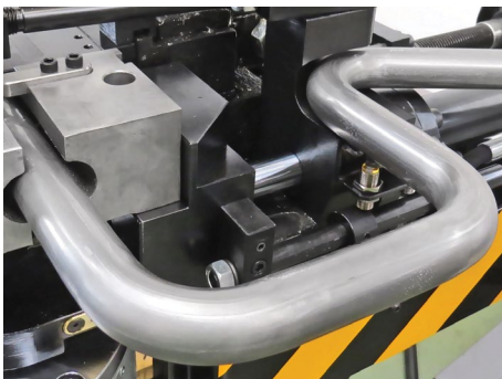
Útiles especiales La máquinas de curvar MDH pueden ser equipadas con herramientas especiales.
