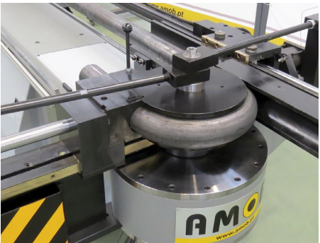
Cilindros de acción directa Los cilindros de mordaza e carril aplican su fuerza directamente en el centro del tubo.
