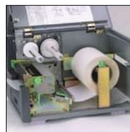
Dispensador y rebobinador del papel base
