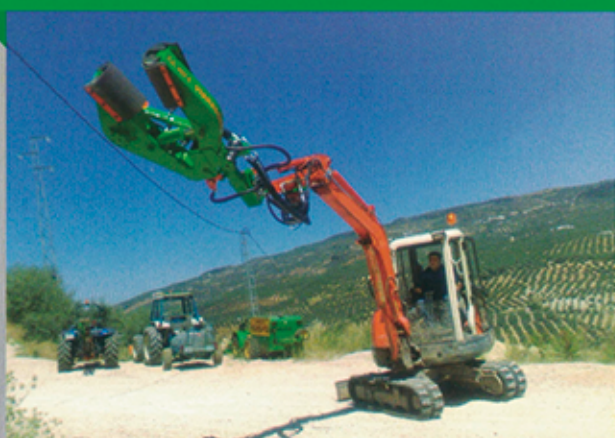
Vibrador en giratoria.
