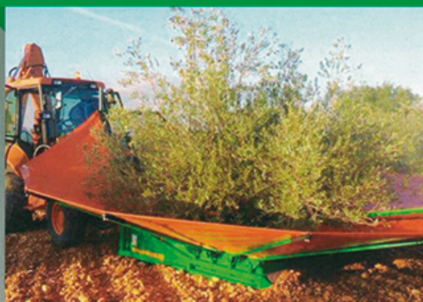
Paraguas en retroexcavadora.
