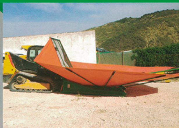
Paraguas en miniexcavadora.
