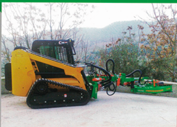
Vibrador en miniexcavadora.
