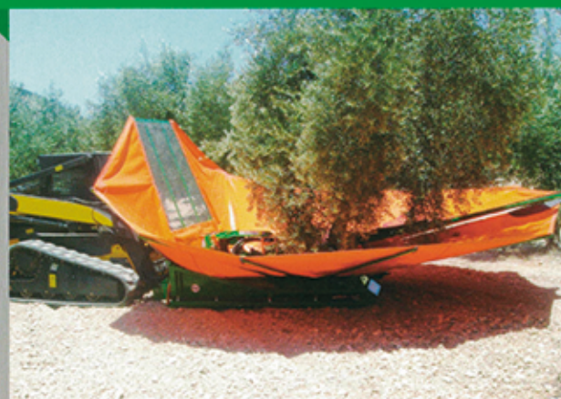
Paraguas en miniexcavadora.
