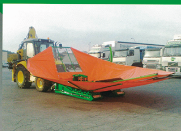
Paraguas en retroexcavadora.
