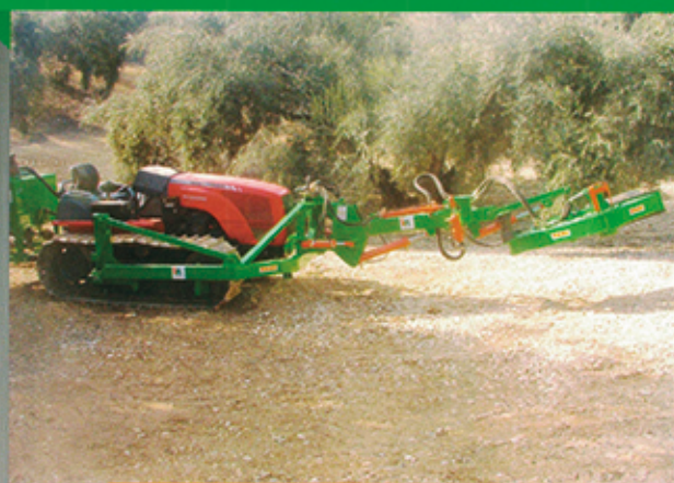
Vibrador en tractor oruga.
