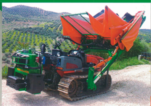
Paraguas en arco en tractor oruga.
