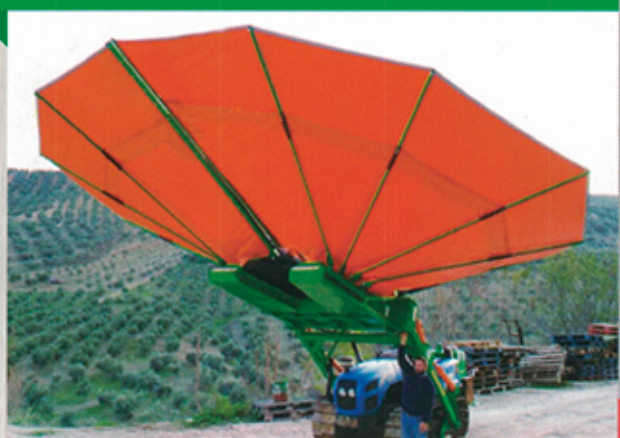
Paraguas en arco en tractor oruga.
