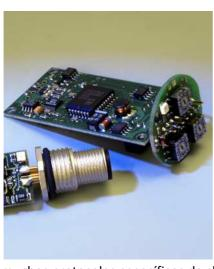
Garma Electrónica presenta unos nuevos conectores que permiten el enlace entre los sensores analógicos, temperatura, célula de carga, serie, digitales, contador ó pulsos y las redes CAN. Permiten conectar casi todo tipo de sensores a los módulos  $\mu$ CAN.
