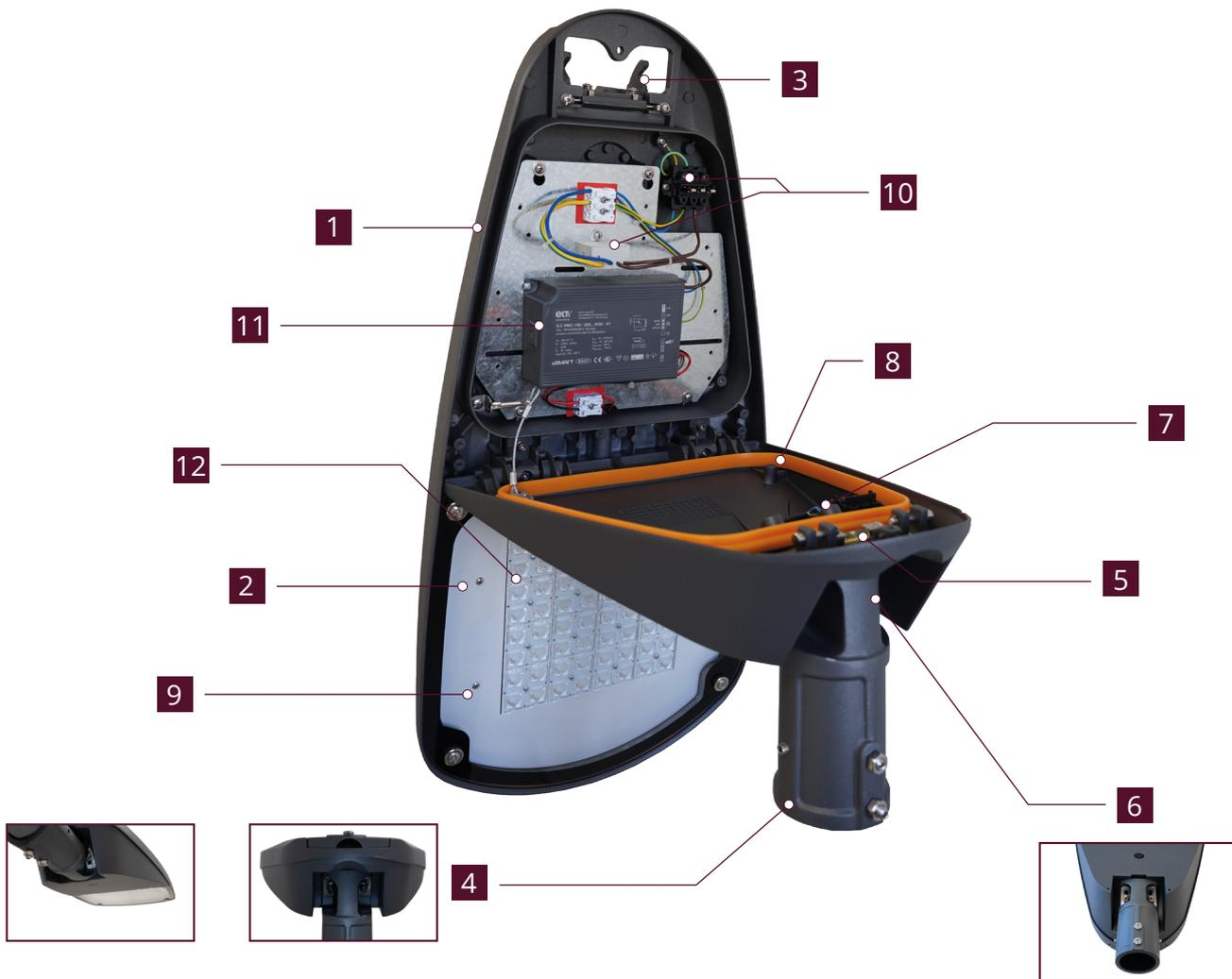
**1- Carcasa:** Aluminio inyectado a alta presión para una alta resistencia a la corrosión con acabado en pintura con recubrimiento de polvo de poliéster, en color gris RAL 7024.
