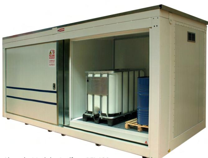
Almacén Modular Ignífugo REI-120 Serie 72500 almacenamiento de 2 clases de productos separados, con puertas correderas cortafuego certificadas, con cierre automático y freno fin de carrera para lograr el correcto cerrado de las puertas. Modelo ideal para bidones de 200 L o recipientes GRG de 1000 L.
