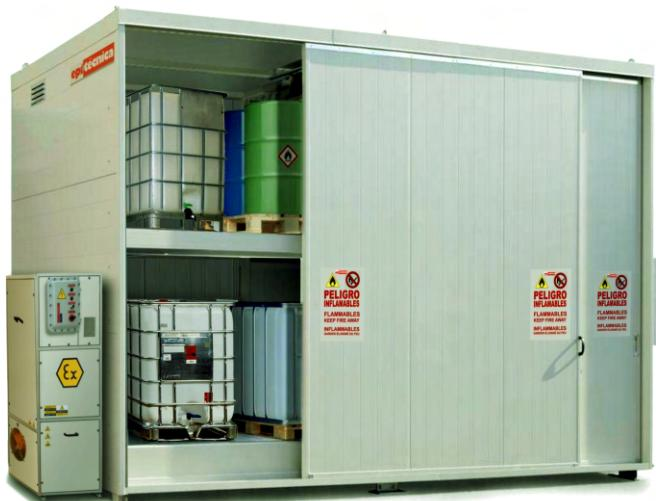
Almacén Modular Ignífugo REI-120 Serie 72800 para 2 niveles de almacenamiento, con puertas correderas cortafuego certificadas, con cierre automático y freno fin de carrera para lograr el correcto cerrado de las puertas. Modelo ideal para bidones de 200 L o recipientes GRG de 1000 L.
