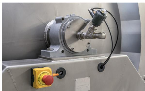
Inyección de agua para lavado automático
