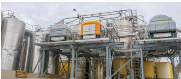
Vaciado directamente en el camión volquete bajo la prensa
