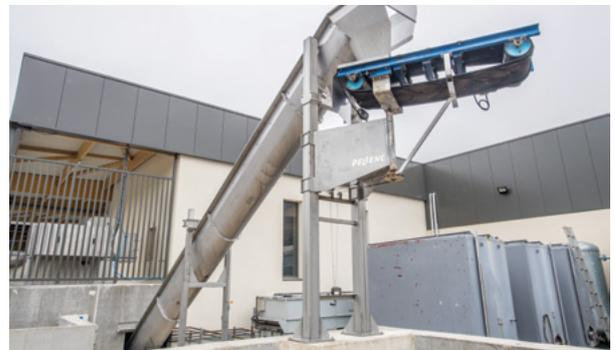
*Evacuación del orujo mediante tornillos sin fin*
