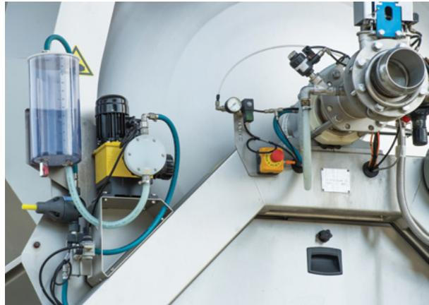
*Conexión del gas neutro al nivel de la entrada axial*
