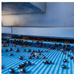
Estabilización de la vendimia y alineación de los objetos frente a las boquillas para mejorar la precisión de la selección (transportador azul ranurado)
