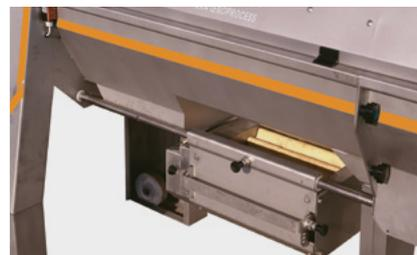
Estrujadora F10 bajo una despalladora H400
