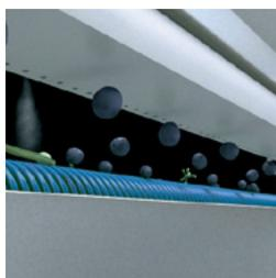
Las boquillas expulsan los elementos no deseables de la vendimia (residuos verdes, granos no maduros o en mal estado sanitario, uvas pasas, etc.) a través del módulo de boquillas de aire comprimido.
