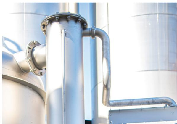
Inyección de uva macerada en caliente en la cuba de expansión
