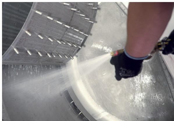
*Rejillas de drenaje Fast Press giratorias para facilitar el lavado*
