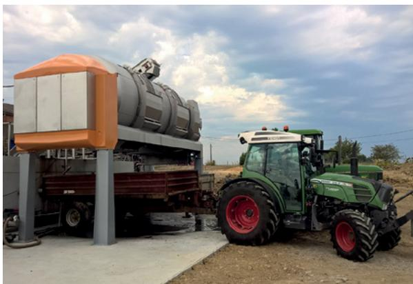
*Vaciado directamente en los remolques situados debajo de la prensa*
