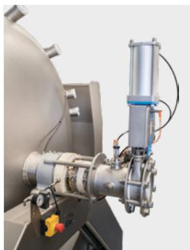
Entrada axial con válvula neumática
