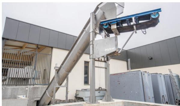
Evacuación del orujo mediante tornillos sin fin
