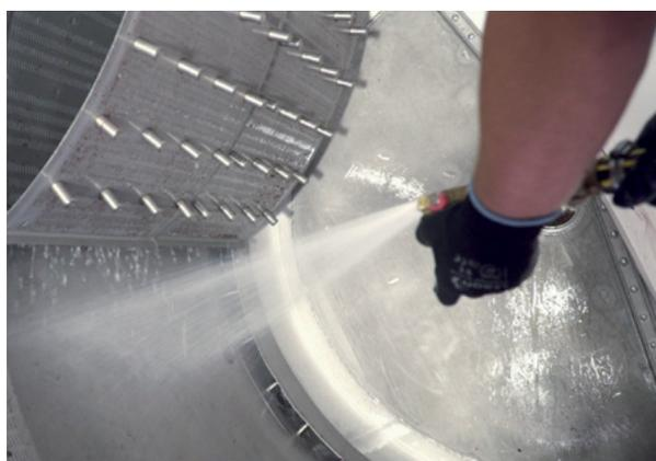
Rejillas de drenaje Fast Press giratorias para un lavado más fácil
