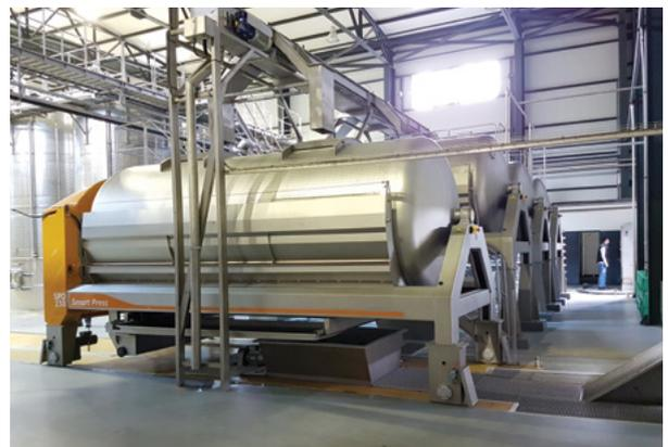
*Evacuación del orujo mediante tornillos sin fin*
