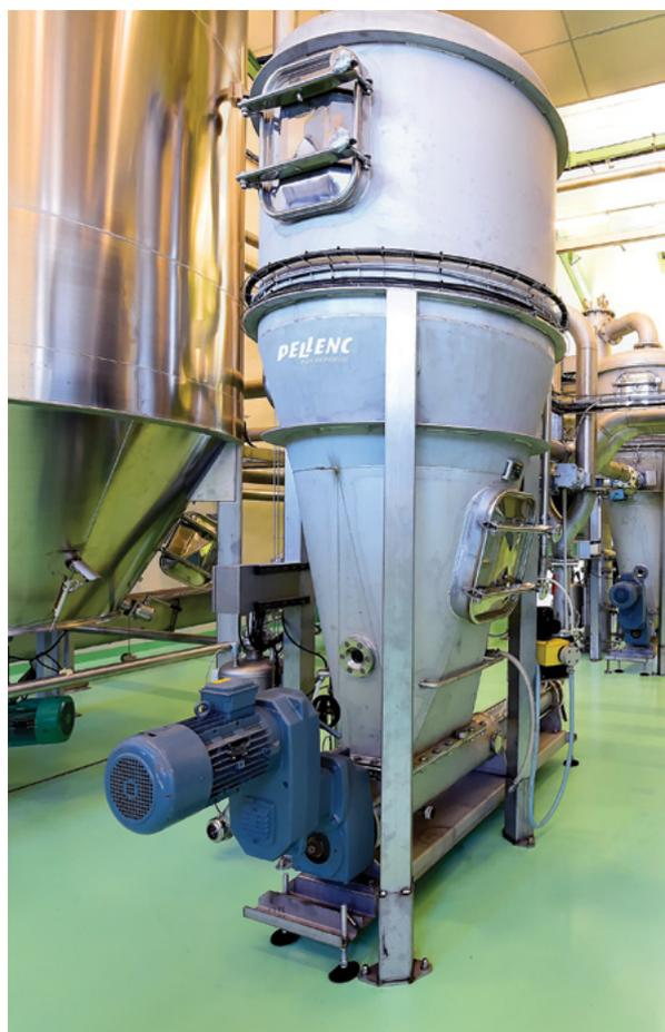
*Cámara de expansión 7 t/h con condensador*
