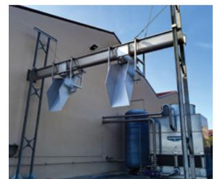
Evacuación del orujo mediante un tornillo sinfín con un sistema de puertas y canalón para el llenado del camión volquete - control neumático de las canaletas y trampillas.
