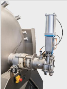
Entrada axial con válvula neumática
