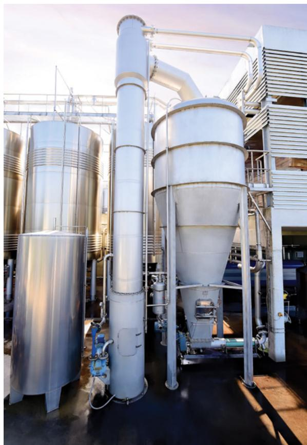
*Cámara de expansión 20 t/h con condensador*
