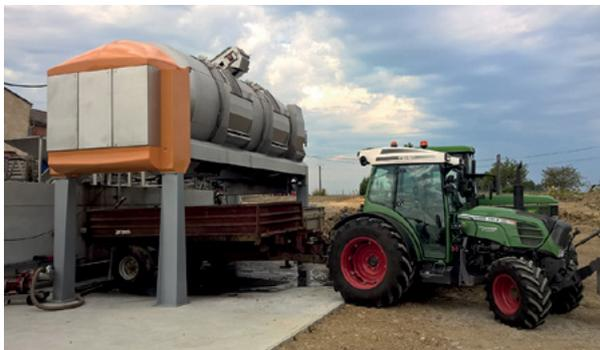
*Vaciado directamente en los remolques situados debajo de la prensa*
