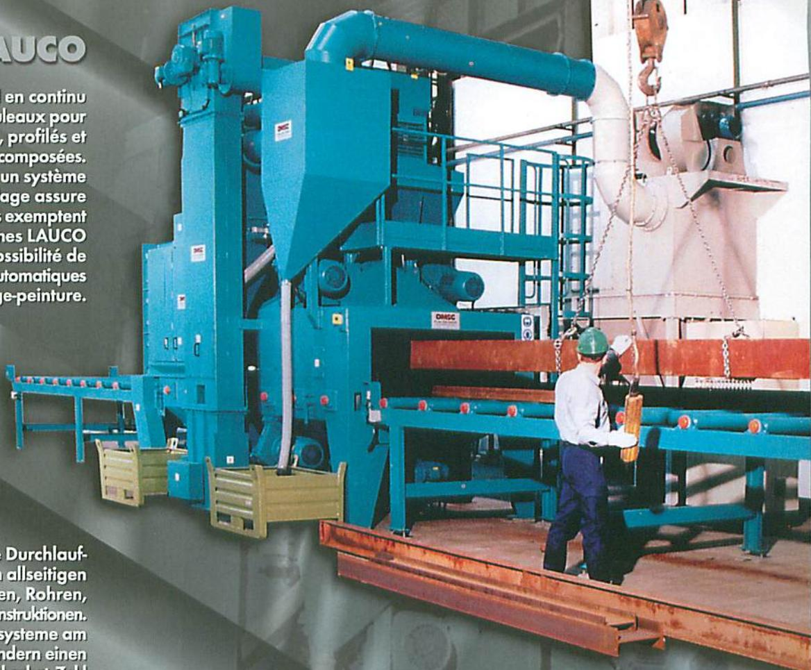
Kontinuierliche Durchlauf-Strahlanlage zum allseitigen Strahlen von Blechen, Rohren, Profilen und Schweißkonstruktionen.
