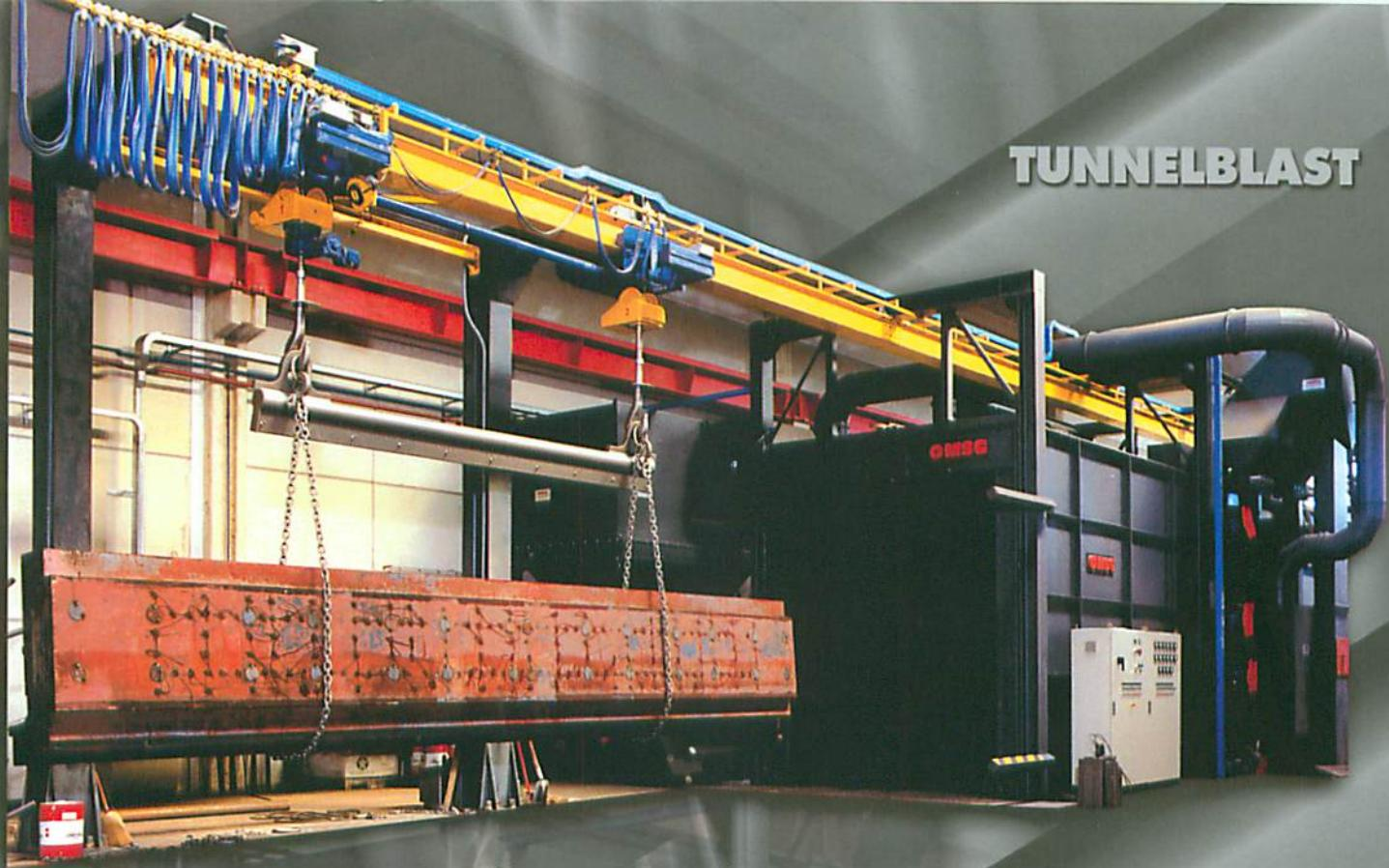
Grenailleuse conçue spécialement pour le traitement d'éléments de moyennes/grosses dimensions en sens horizontal. La manipulation des pièces peut être effectuée par un double palan, par un convoyeur aérien ou par chariots motorisés à terre. Le grenaillage est effectué simultanément sur toute la surface de la pièce pendant la translation au travers du tunnel.
