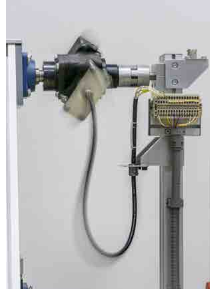
Prueba de torsión en centro de ensayos LAPP
