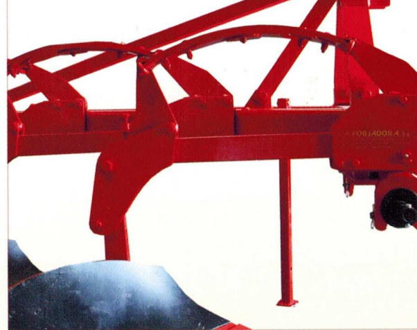
Doble sistema de seguridad por ballesta y fusible de acero.
