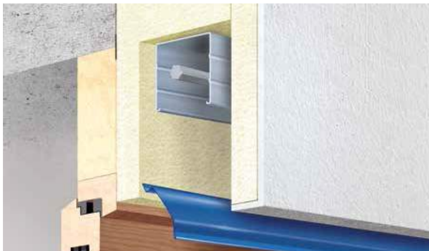
Sección horizontal para accionamiento por manivela articulada
