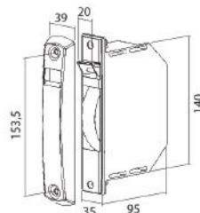
Modelo UNIVERSAL con placa de aluminio. Cajetín sin pivot de empotrar en guía con cinta de 20 mm.
