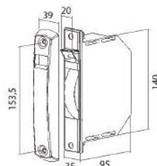
Modelo UNIVERSAL con placa de aluminio. Cajetín con pivot de empotrar en guía con cinta de 20 mm.
