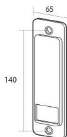
Placa de acero para recogedor metálico modelo PEQUEÑO.
