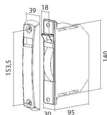
Modelo UNIVERSAL con placa de aluminio. Cajetín con pivot de empotrar en guía con cinta de 18 mm.
