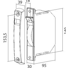
Modelo UNIVERSAL con placa de aluminio. Cajetín sin pivot de empotrar en guía con cinta de 18 mm.
