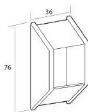
Carcasa de plástico estrecha para pasacintas metálico cinta de 22 mm.
