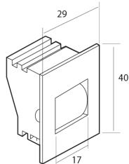
Pasacintas nylon para cajón compacto de PVC con felpudo hasta cinta de 18 mm.
