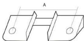
Ángulo metálico de inclinación para pasacintas metálico cinta de 14 mm.
