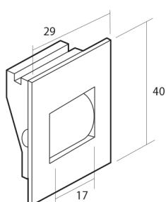
Pasacintas nylon para cajón compacto con ranura especial hasta cinta de 18 mm.
