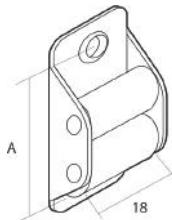
Pasacintas metálico con rodillo de nylon para cinta de 14 mm.
