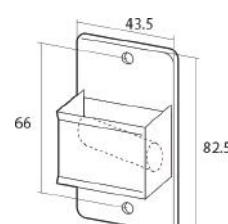
Pasacintas metálico con rodillo inclinado para cinta de 14 mm.
