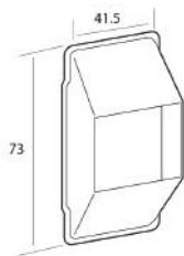
Carcasa de aluminio para pasacintas metálico cinta de 22 mm.
