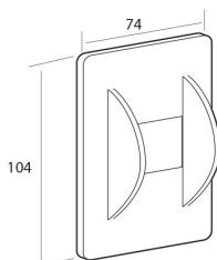
Carcasa de plástico ancha para pasacintas metálico cinta de 22 mm.
