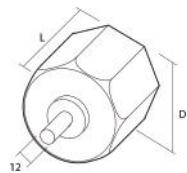
Cápsula metálica con espiga metálica de Ø 12 mm.
