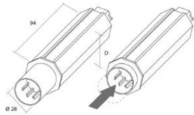
Cápsula especial telescopica con muelle para rodamiento de Ø 28 mm.
