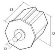
Cápsula de plástico con espiga metálica de Ø 12 mm.
