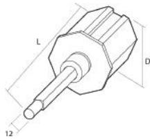
Cápsula regulable de 200 mm. con espiga larga de Ø 12 mm. en Zamak.
