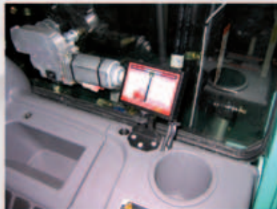
// Indicador de inclinación del mástil
