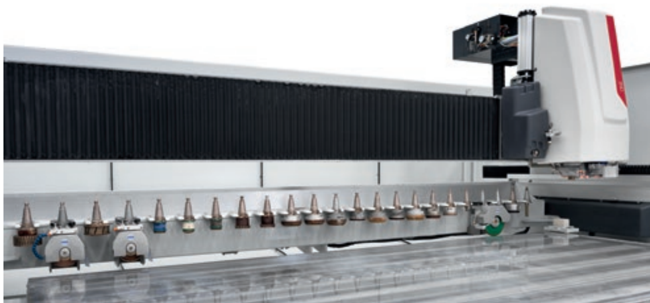
Almacén trasero de herramientas con 23 posiciones.
