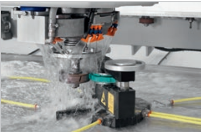
Dynamic lock en pieza pequeña de 30 mm.
