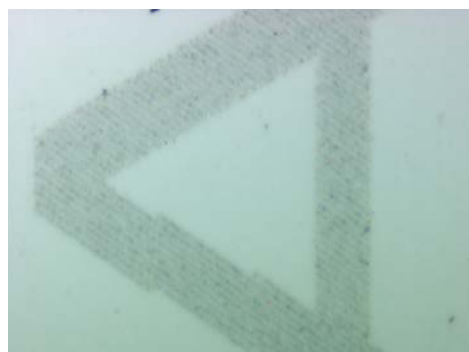
Marcado usando un tipo de láser YAG sobre pintura especial.
