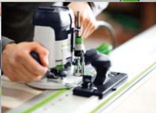
Fresado recto en la superficie: el riel de guía es ideal para el fresado de una ranura en la pared dorsal de la superficie.
