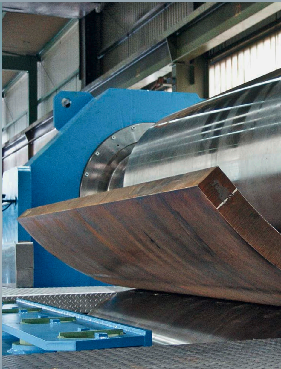
▼ Tecnología de conformación/Mecanizado de chapas, Haeusler | Suiza | Dobladora de chapa para la producción de tubos de grandes dimensiones con cordón de soldadura longitudinal www.haeusler.com
