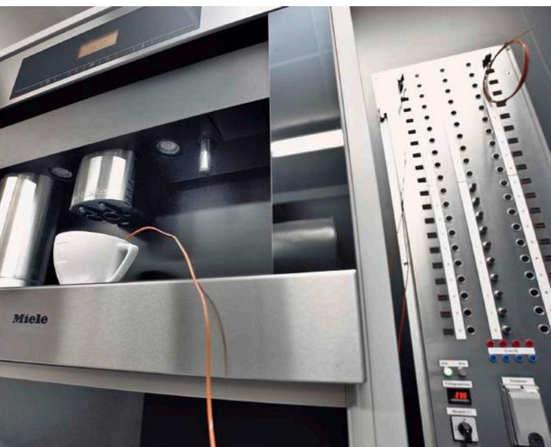
Medición de temperatura de alta precisión y registro de señales en el sistema de control de calidad de Miele
