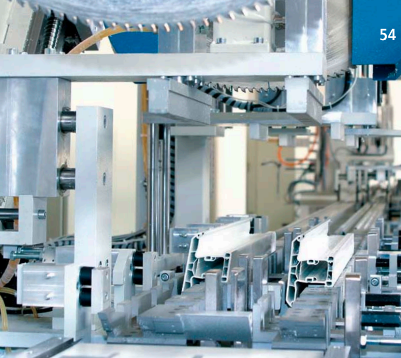
▲ Máquinas para la fabricación de ventanas, BJM | Alemania | Máquina para el mecanizado de perfiles totalmente automática para ventanas de material plástico y aluminio www.bjm-gmbh.de
