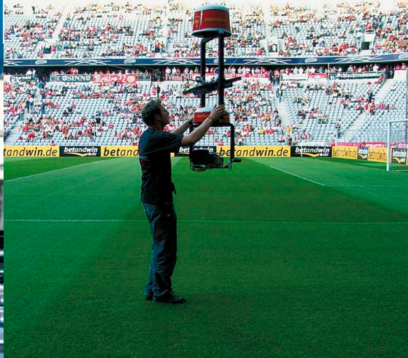
▲ Técnica de escenarios y espectáculos, SpiderCam | Austria | SpiderCam permite el movimiento tridimensional de cámaras en espacios abiertos. www.spidercam.tv
