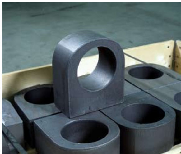
Piezas en bruto de portacojinetes cortadas mediante oxicorte.
