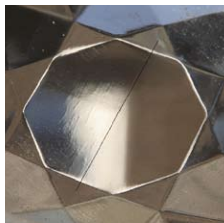
La mitad de la zona central se reprocesa después de quejas de superficie de "corteza de naranja".
