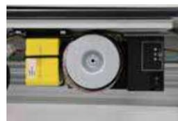
Transformador, baterías 24V Ni-Cd, interruptor de encendido-apagado
