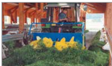
Distribuidor de forraje con pala niveladora e indicador preciso de profundidad (Plantar)
