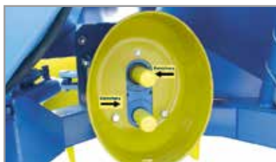
Engranaje para uso frontal o trasero (reequipable en todo momento)
