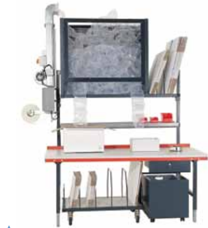
Mesa de embalaje con una máquina Air+ integrada con silo. Un sensor controla la cantidad de llenado del silo y pone en marcha o detiene la máquina según la necesidad.
