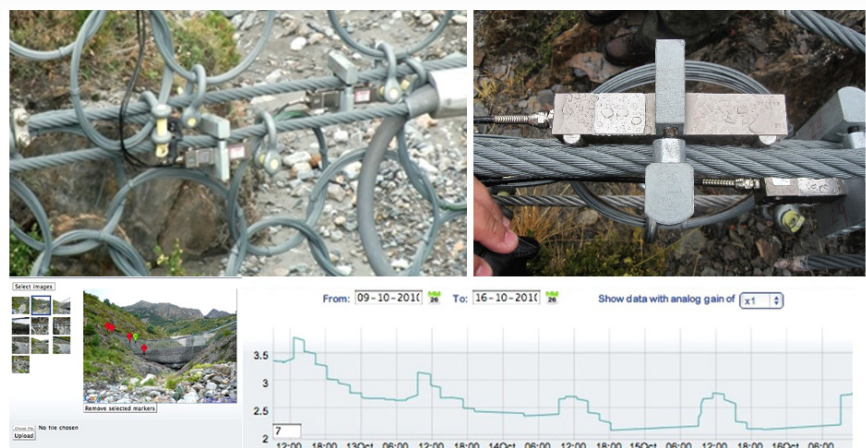
Fig. 1 Primeros sensores de carga. Estación de Erill, Pirineo (2010).
