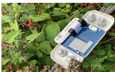
Fig. 3 Modelos de la generación 2019 (Smartbox) con mayor nivel protección al intemperismo.
