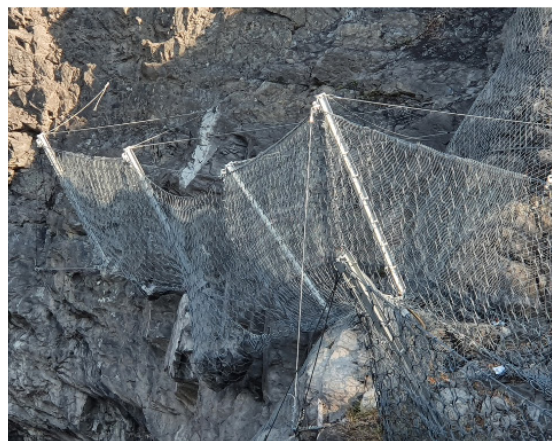
Fig. 18.- Impacto de mayor aceleración 17,3 g sobre la misma barrera.
