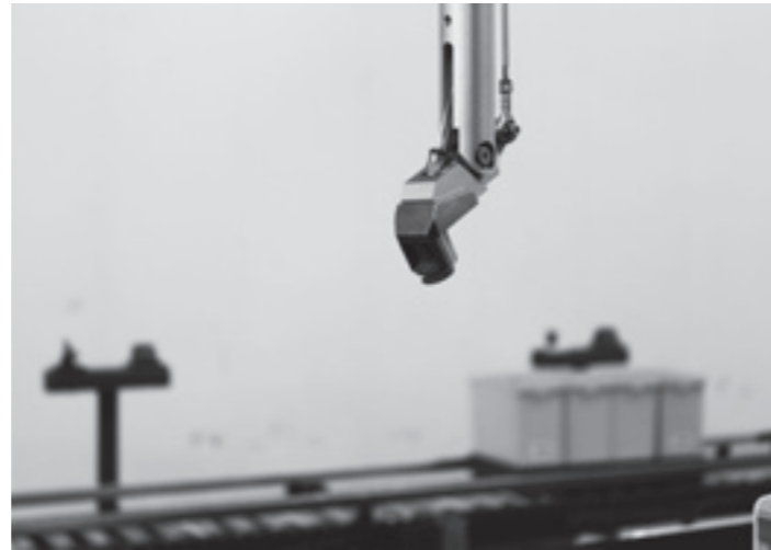
2 La unidad de toma se posiciona sobre el artículo con ayuda del robot de brazos articulados
