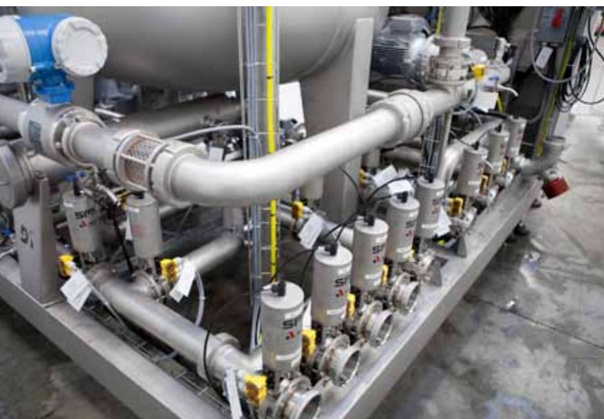
El uso de la MEMBRANA SÓLIDA ASIMÉTRICA garantiza una mayor resistencia mecánica y un amplio margen de funcionamiento. Permite efectuar la limpieza con productos agresivos sin deterioro alguno. Con este tipo de membranas, el "back-wash" puede ocurrir a presiones más altas y con regímenes más eficientes, realizando ciclos de filtración más largos. La membrana sólida asimétrica permite que el filtro trabaje con presiones más altas que cualquier otro sistema.
