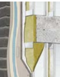
Montante doble + placa intermedia
