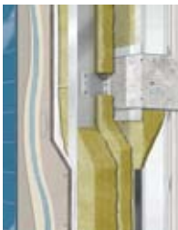
Montante doble con perfiles exteriores continuos
