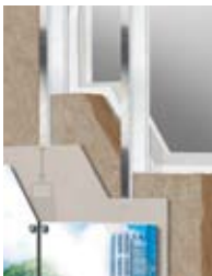
Montante sencillo: barrera térmica
