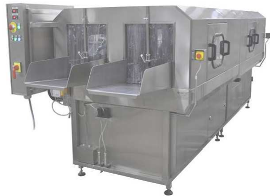
STRM – 20.0159.22 – con sistema automático de detergente – filtro de tambor STRM – 20.009.22 – with automatic systems for detergent filling and dosing – drum filter STRM - 20.009.22 - avec systèmes automatiques remplissage détergent et de dosage - filtre à tambour
