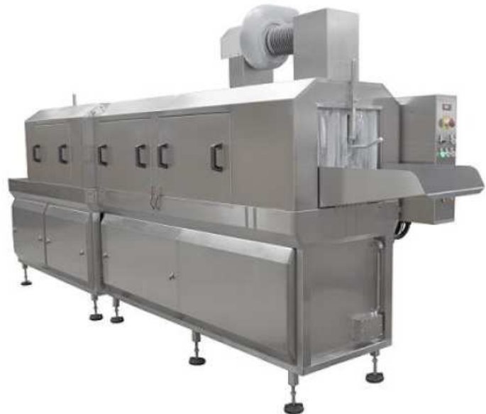
STRM-20.0222.00 - pour 240 boîtes - avec ventilation - couvercles latéraux en métal - interrupteurs de sécurité
