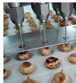
Cinta con moldes para posicionar el producto.
