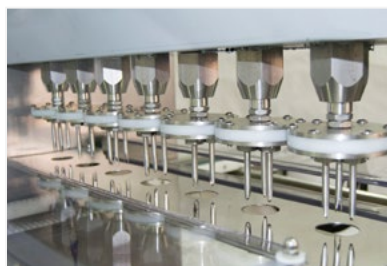
Agujas inyectoras dispuestas en círculo
