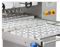
Cinta transportadora con sistema para trabajar con varias medidas de bandeja.
