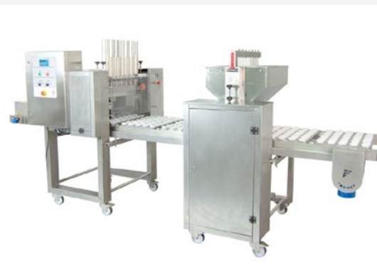
Línea de trabajo para elaborar magdalenas. Compuesta de un cargador de bandejas, una capsuladora-desmoldeadora de cápsulas de papel y una dosificadora.
