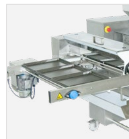
Transportador diseñado para situar tres bandejas planas.
