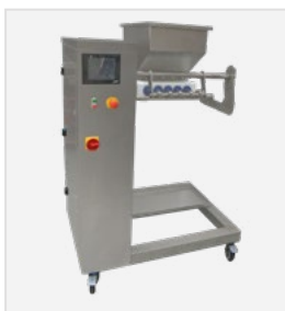
MAS con cabezal suspendido para acoplar a cinta transportadora en línea de producción.
