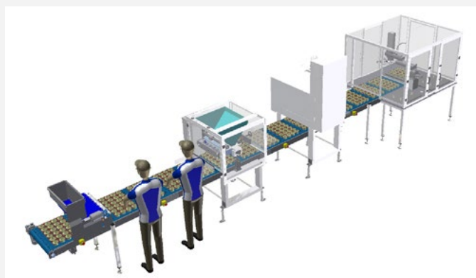
Línea de trabajo para la producción de muffins y macarons.
