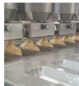
Boquillas con salida doble para repartir el producto en los moldes.
