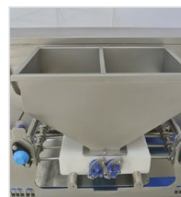
Doble depósito para masa de dos colores.
