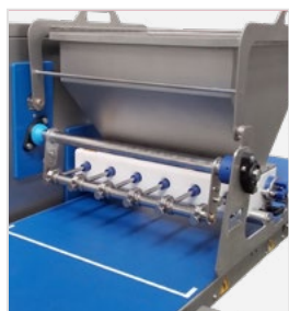
MAS con cinta transportadora adaptada para el dosificado en continuo de plancha de bizcocho.
