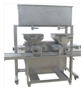
Doble depósito para masa de dos colores
