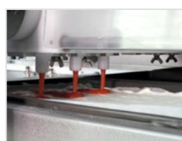
Boquillas antisalpicadura para masas más líquidas.
