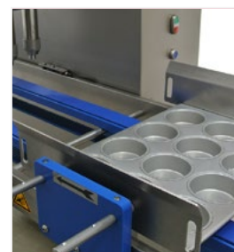
Cinta de arrastre con sistema para colocar bandejas de diferentes medidas.
