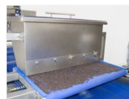
TPT - Topping automático de cinta, para virutas de chocolate, trozos de nueces, almendras, etc.
