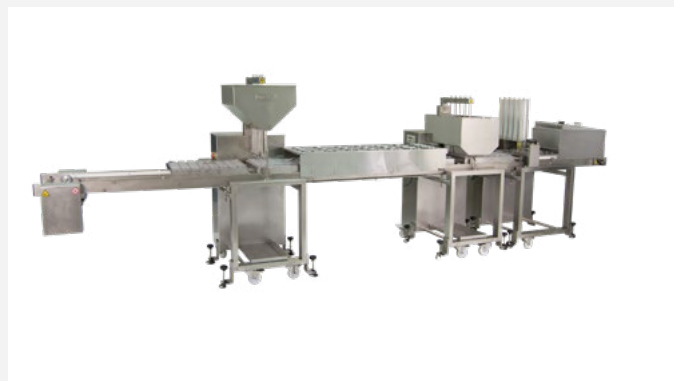
Línea de trabajo para la elaboración de flanes. Compuesta de un cargador de bandejas, depositador de vasos, dosificador de caramelo, zona de enfriamiento, dosificadora de flanes y termo-sellado de la tapa. El producto queda listo para su posterior empaquetado y refrigerado.
