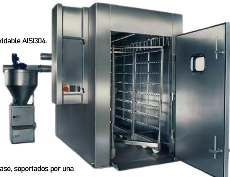
El horno está construido en módulos: delantero, trasero y base, soportados por una estructura tubular forrada con paneles INOX y con aislamiento térmico en el interior.
