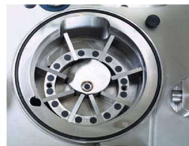
L'**Insacatrice continua sottovuoto F9** è una macchina compatta ideale per l'artigianato e per la piccola impresa. La Pompa di insacco a palette di piccolo diametro può essere dotata di 8 o 12 palette.
