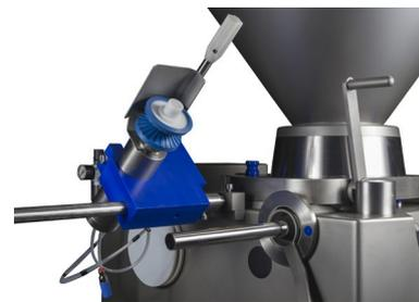
Il passaggio dell'insacco in continuo al processo di attorcigliatura avviene rapidamente e senza attrezzi.
