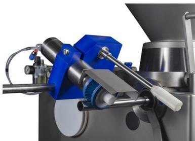
L'Arricciatore permette di incrementare la produttività dell'operatore quando viene usato budello naturale. Un motore pneumatico consente di inflare rapidamente negli imbusti d'insacco tutti i budelli naturali senza danneggiarli.
