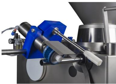
L'Arricciatore permette di incrementare la produttività dell'operatore quando viene usato budello naturale. Un motore pneumatico consente di inflare rapidamente negli imbuti d'insacco tutti i budelli naturali senza danneggiarli.
