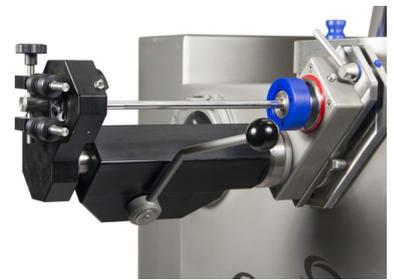
Il dispositivo Attorcigliatore permette di essere approntato rapidamente senza uso di utensili.
